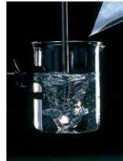
1.プロペラ型攪拌機などで水を強攪拌して渦を作り、できた渦の壁面へアルギン粉末を少しづつ撒きかけるように投入します。
