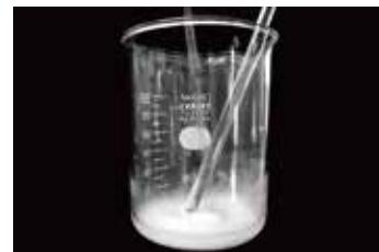
2. スラリーに水を加えます。※このとき、アルギン粉末が沈殿しないように搅拌しながら一気に水を加えるのがコツです。
