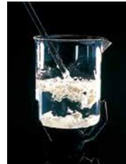
粉末投入時に適切に分散されないと、粉の表面が濡れて固まり、大きなダマ(ママコ)を生じてしまいます。ママコ状態から全ての粉が均一に溶けるまでには、かなり長い時間を要します。
